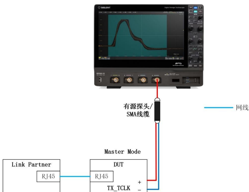
图 10-4 有时钟无滤波主模式抖动测试的连接
